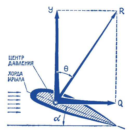
Есть ещё одна неочевидная особенность. Давление воздуха снизу пластины и разрежение сверху распределены неравномерно. В результате этого оказывается, что если сложить всё вместе и заменить одной силой с таким же действием, то это сила будет приложена не посредине хорды, а. примерно на расстоянии одной трети хорды от передней кромки. Точка приложения этой равнодействующей называется «центр давления»
