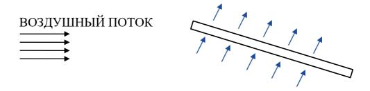
Всё вместе — давление снизу и разрежение сверху, складываясь, со создают усилие F, которое толкает пластину вверх и в направлении потока воздуха. Та часть усилия. которая толкает вверх называется «подъёмная сила», а та часть, чтовлечёт пластину вместе с потоком — «сопротивление»
