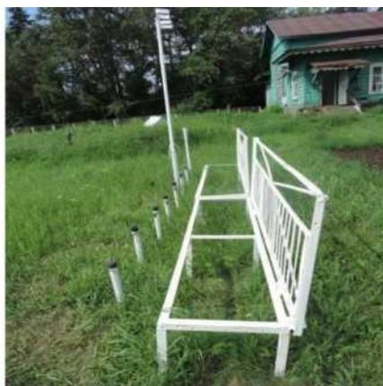
Рисунок 1.1 - Вытяжные почвенно-глубинные термометры ОГМС Иркутск
