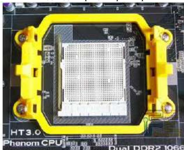
Как Вы можете видеть, при таком подходе сила прижимного давления от радиатора передается сначала непосредственно на пластмассовую основу (рамку) и уже потом равномерно распределяется по текстолиту самой материнской платы.
