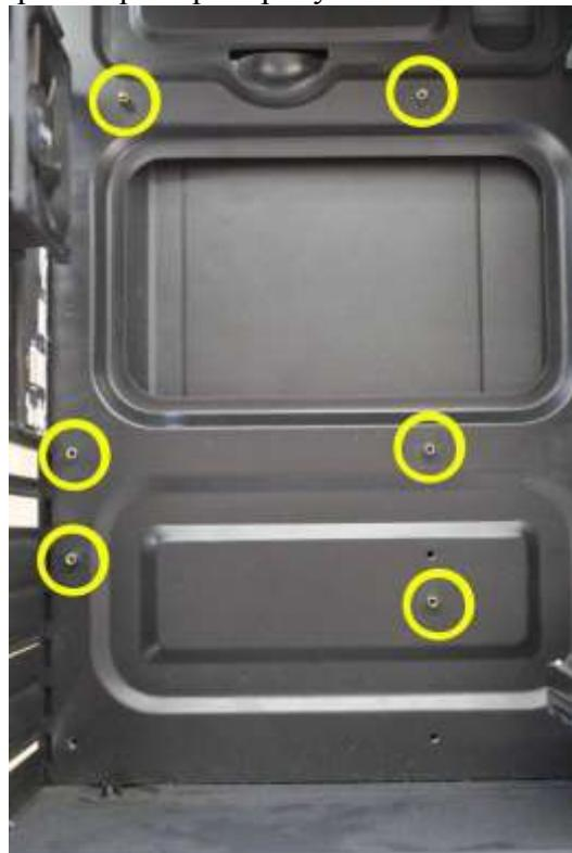
Рисунок 1 – Стойки, установленные на раме корпуса ПЭВМ
