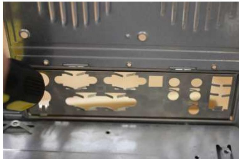
Рисунок 4 – Монтаж I\O Plate
