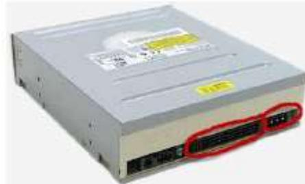
Большим овалом обозначено место подключения кабеля данных, а меньшим - питания. Вообще, здесь все точно так же, как и в случае подключения жесткого диска.
