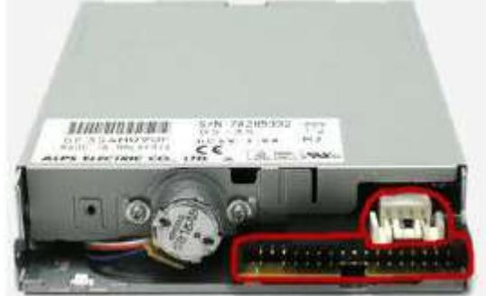
Большой овал - разъем подключения кабеля данных, белый с четырьмя контактами - разъем питания. Кабель данных дисковода чуть уже, чем «IDE шлейф» жесткого диска, так что перепутать и подключить неправильно Вы не сможете.
