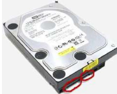
У жестких винчестеров стандарта «IDE» кабели передачи данных и разъемы питания самого винчестера выглядят по другому. Разъем кабеля данных - (больший) и питание - (меньший).
