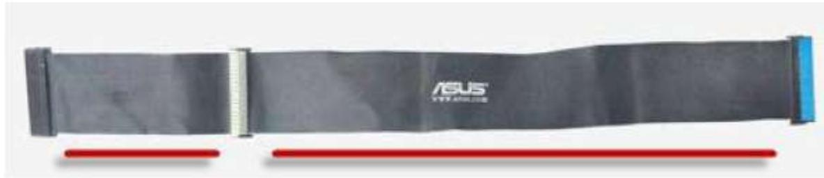
Согласно спецификации окончание более длинного отрезка кабеля подключается к плате, а оставшиеся два разъема (на более коротком отрезке) - к устройствам. Причем «Master» находится всегда на конце кабеля, а «Slave» - ближе к середине.
