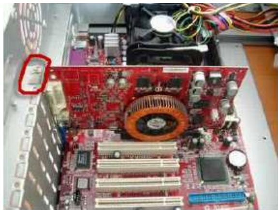
На самом разъеме под видеокарту на материнской плате есть специальный фиксатор, который дополнительно "придерживает" карту в слоте.
