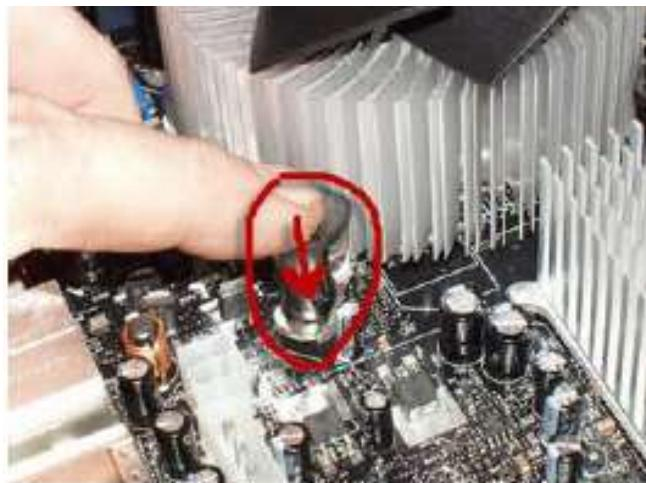
Совет: После размещения зажимов радиатора строго над отверстиями вокруг посадочного слота одновременно плавно но сильно нажимаем на два зажима, расположенных по диагонали друг от друга (до щелчка и надежной фиксации их в плате).
