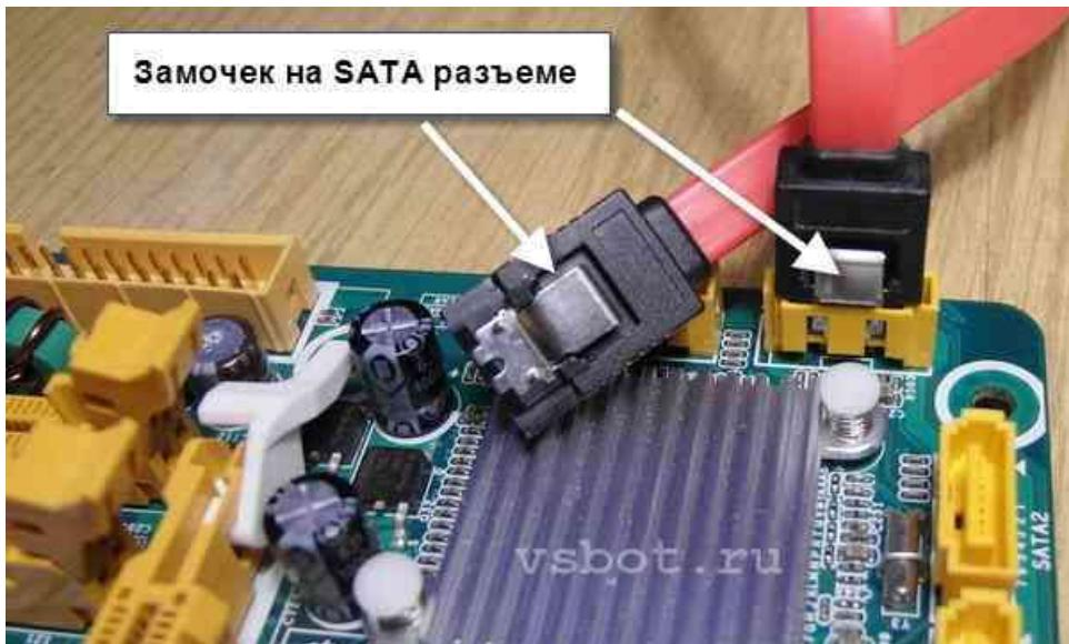
Кабель SATA — это одно из слабых мест компьютера. Бывают кабели с «замочком» и без. Кабели с «замочком» обычно идут в комплекте с материнской платой. «Замочек» (упругая металлическая пластина) дополнительно поджимает контакты кабеля к контактам винчестера. *Соединение получается более надежным.*
