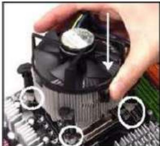
В теории это выглядит следующим образом: по четырем углам от процессорного слота есть специальные отверстия в материнской плате, именно через них и крепится радиатор с куллером. Соответственно на радиаторе есть четыре специальных пластмассовых зажима, которые, при надавливании, фактически прижимают радиатор с процессором друг к другу и защелкивают всю систему на материнской плате. А это - один из его фиксаторов на плате крупным планом.
