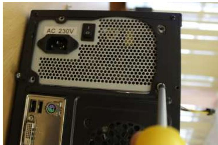
Рисунок 7 – Фиксация блока питания
