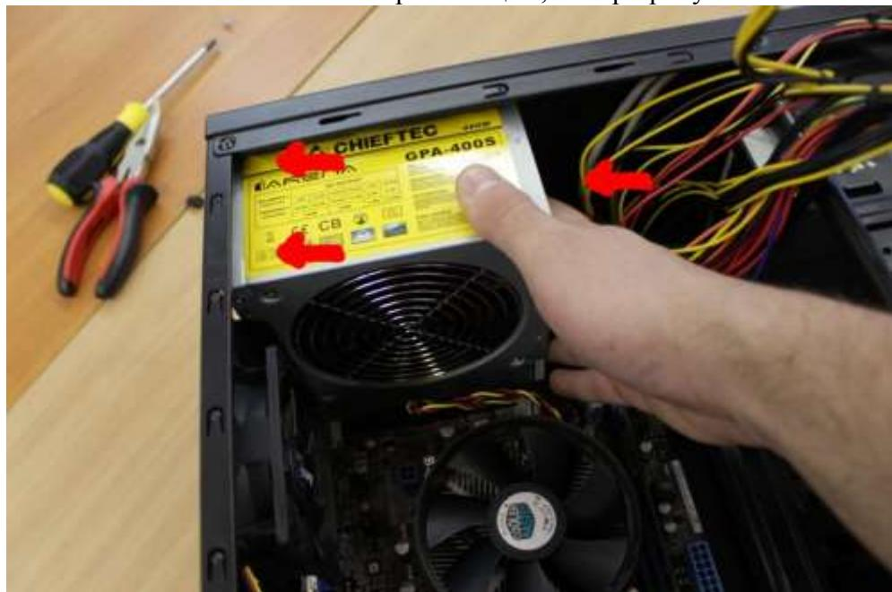
Рисунок 6 – Установка блока питания
