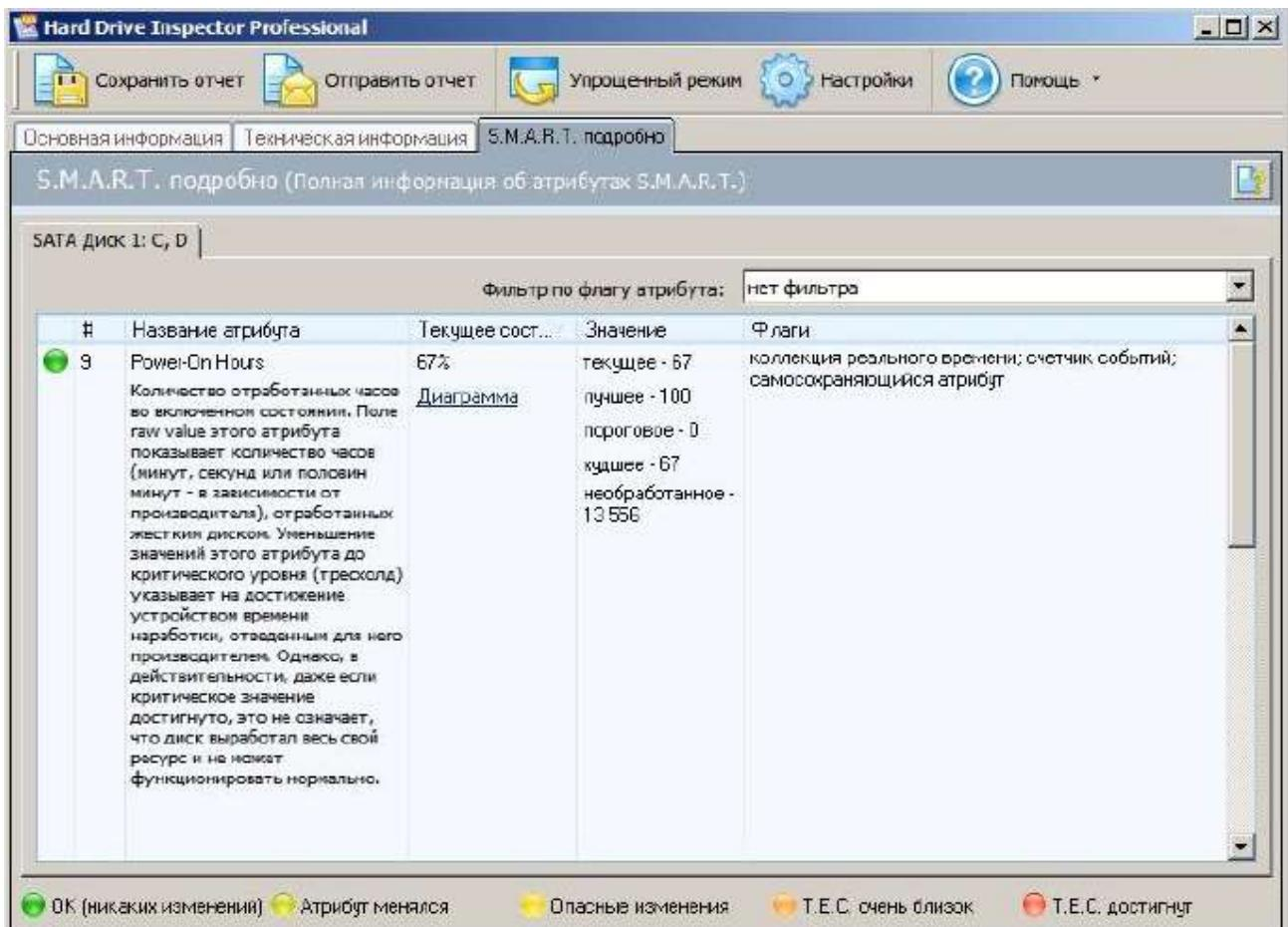
Рисунок 3 – Количество отработанных часов во включенном состоянии
