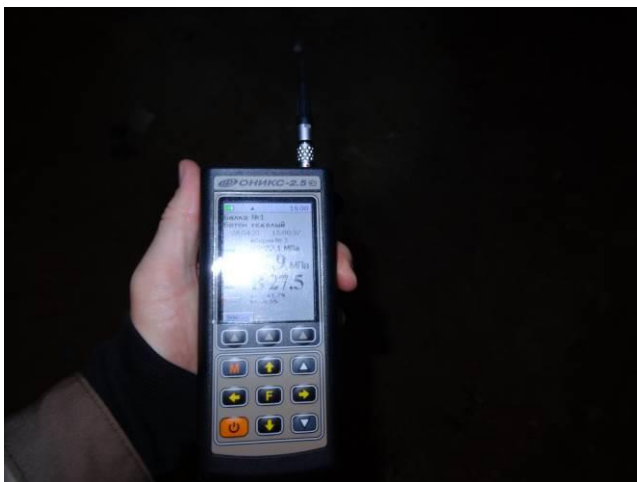
Ф.1.13. Определение прочности бетона
