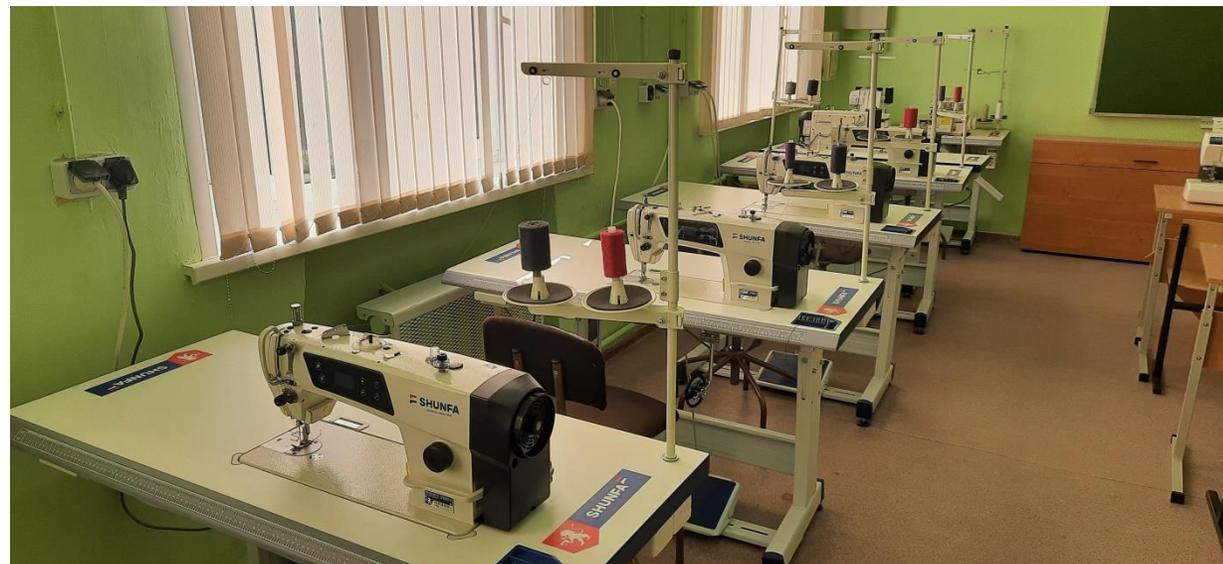
Производственные прямострочные швейные машины с промышленным столом
