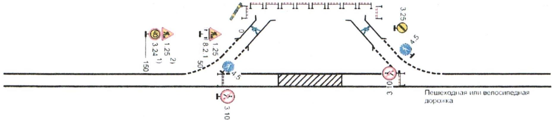
Двухполосная дорога. Рабочая зона производства долговременных работ на пешеходной (велосипедной) дорожке (тротуаре).
